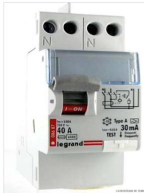
Le dispositif de protection à courant différentiel résiduel détecte les courants de fuite vers la terre et coupe l'alimentation du circuit respectif dès que la valeur du courant de défaut atteint la sensibilité du dispositif différentiel. Ce dispositif offre une excellente protection contre les risques d'électrocution, d'incendies ainsi que contre les consommations supplémentaires dues aux pertes de courant.
